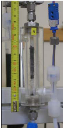
Figura 3: Reattore catalitico per la reazione di idrolisi del NaBH_4
